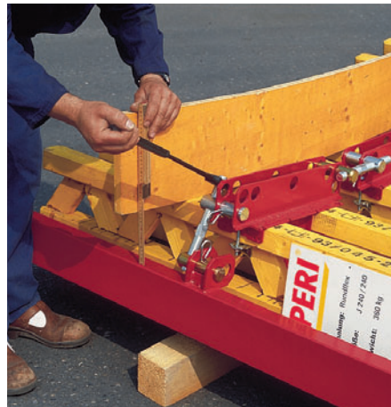
Podešavanje ivičnog profila putem Rundflex navoja 210 vrši se pomoću kombinovanog ključa SW 24.
